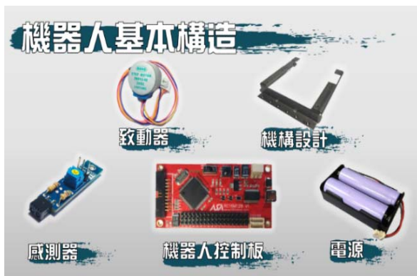
圖四：傻寶機器人基本構造 （資料來源：國立中央大學機器人研究社（2020）。機器人教學-原理。2020年10月1日，取自 https://reurl.cc/r89ooy ）
